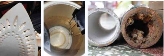
可惡的粉抹水垢損害蒸氣熨斗及水煲 水垢沉積在水管壁，令家中煤氣熱水爐不能起動，工業鍋爐會爆炸
